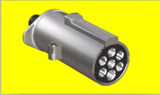
06 0405 ALUMİNYUM RÖMORK FİŞİ ERKEK N TİP ALUMINIUM - TRAILER PLUG 7 PINS N TYPE ISO 1185-DIN 72579-N. 24V
