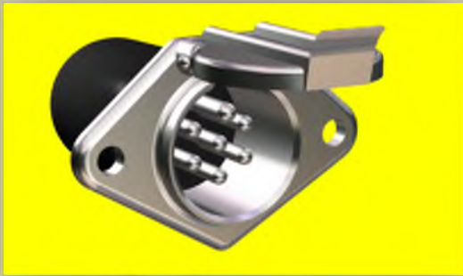
06 0407 ALUMİNYUM RÖMORK FİŞİ DİŞİ N TİP ALUMINIUM - TRAILER SOCKET 7 PINS N TYPE ISO 1185-DIN 72579-N. 24V
