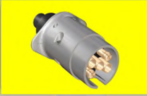
06 0102 ALUMİNYUM RÖMÖRK FİŞİ ERKEK 5'Lİ ALUMINIUM - TRAILER PLUG 5'PINS. DIN 72576-N.
